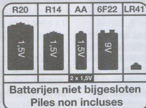
Consultez les indications reprises sur l'emballage des piles achetées. Insérez des piles (2x 1,5V AA (LR6)) neuves dans le compartiment prévu à cet effet en vérifiant le sens.
